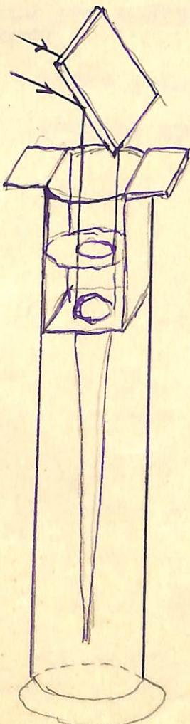
Подтвердим это на опыте. Возьмем стеклянный цилиндр, возможно более высокий, вложим в него сверху жестяную пластинку, согнутую так, как показано на рисунке, предварительно вырезавши в ее нижней части круглое отверстие, диаметр ~~которое~~ <sup>(какой имеет)</sup> немного меньшего, чем исследуемая линза.
