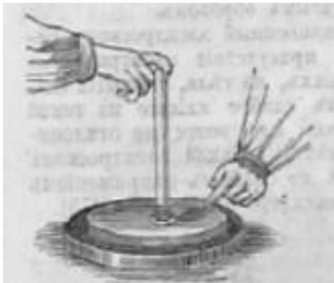
Электрофор состоит из смоляного или каучукового кружка и металлического кружка, снабженного изолирующей ручкой.
