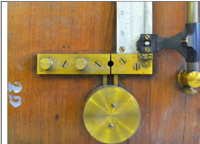
Фото 1. На переднем плане: защитный кожух резистора и «узел» - плоская медная шина с двумя клеммами. Справа вверху: движок с платиновым контактом в виде вращающегося цилиндра и фрагмент шкалы
