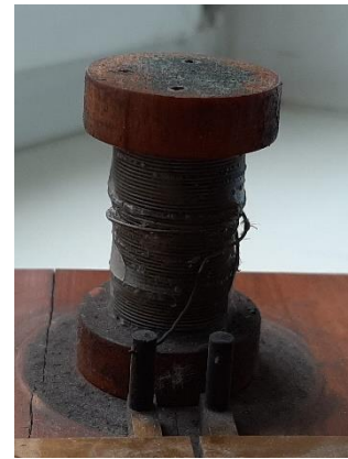
Фото 2. Дополнительный резистор без кожуха: на деревянную катушку бифилярным способом намотан провод, слой которого изолирован лаком. Для выведения дополнительных резисторов из цепи прилагались два штекера (не сохранились)
