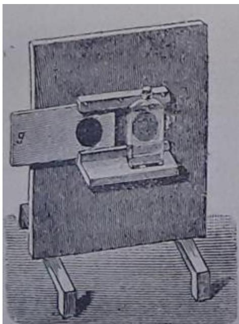
Прибор состоит из квадратной доски с двумя круглыми отверстиями, которые могут закрываться цветными стеклами (*g*) или сосудами (*p*) с параллельными стенками, наполненными окрашенными жидкостями.
